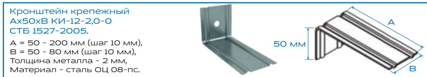
Крепежные кронштейны должны устанавливаться в проектное положение и крепиться анкерными устройствами к стене с полной затяжкой. Крепежные кронштейны устанавливаются по заранее нанесенной разметке. Тип и длина анкерных устройств и крепежных элементов зависит от материала облицовываемой стены.
