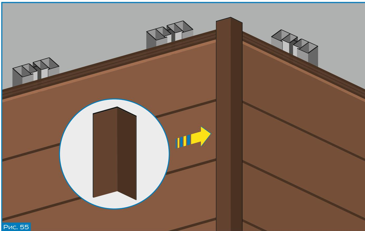
Углы и стыки закрываются уголками, либо самой доской при помощи запила под углом 45 градусов и усиления угловым крепежом (рис. 55).
