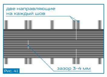
Каждый торец фасадной панели, должен быть смонтирован на отдельно стоящую направляющую (рис. 41).
